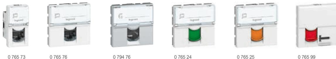
Bases con conector de conexión rápida sin herramienta. Acepta cables unifilares AWG 22 hasta AWG 26 y multifilares AWG 26. Identificación de los contactos por doble código de color y cableado 568 A et B. Conformes a las normas ISO/IEC 11801 edición 3.0 (2017) y EIA/TIA 568 C2-1
