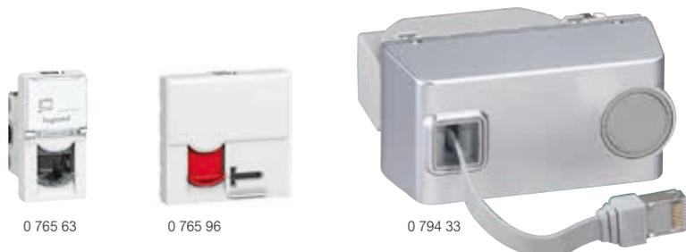
Bases con conector de conexión rápida sin herramienta. Acepta cables unifilares AWG 22 hasta AWG 26 y multifilares AWG 26. Identificación de los contactos por doble código de color y cableado 568 A et B. Conformes a las normas ISO/IEC 11801 edición 3.0 (2017) y EIA/TIA 568 C2-1
