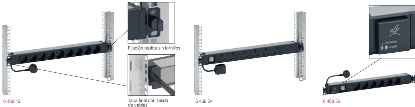
Para el suministro de energía eléctrica a los equipos IT en racks de 19". Alimentación 250V - 50/60 Hz. Perfil de aluminio 1U y 19". Tapa final con soportes metálicos y salida de cables. Instalación rápida sin tornillos en montantes 19". Pueden instalarse verticalmente cambiando de posición los soportes.
