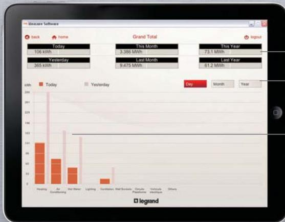
Ejemplo de pantalla de visualización del consumo total de calefacción de un dispositivo durante un mes
