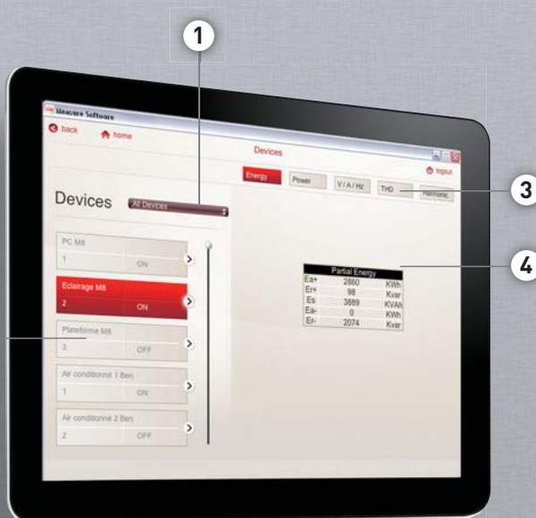
Ejemplo de pantalla de visualización de la medida de una central con circuito de alumbrado
