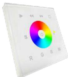
Controlador ideal para instalaciones sencillas. Dispone de panel touch diseñado de acuerdo al protocolo estándar DMX 512. 4 Canales RGBW, permitiendo un ajuste de tono de color rápido y preciso mediante rueda de color.
