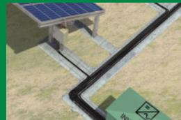
**3** Instalación BT DC entre las cajas de conexión y los inversores
