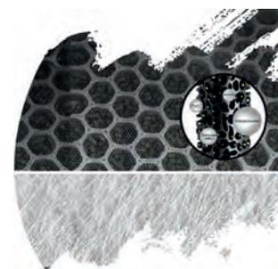
Detalle filtro compuesto HEPA + Carbón activo
