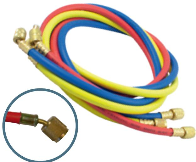
Kit de tres mangueras flexibles para el vacío y carga para gases con conexiones 1/4" SAE, variaciones de 5/16", sin válvula, tubo con barrera de nylon, O-ring 1/4" SAE, Presión máxima 60 bar.
