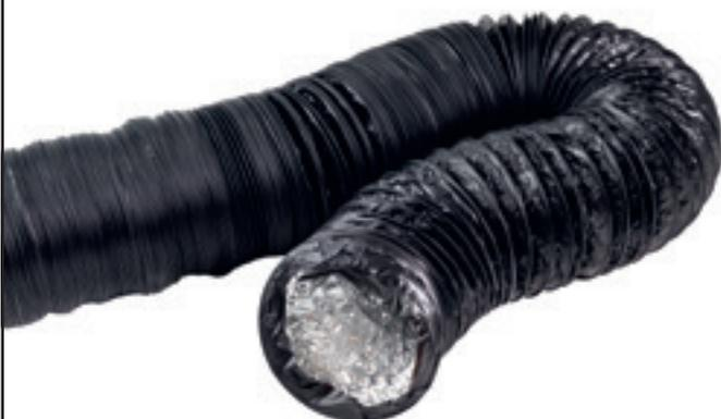
Conducto flexible aislado fabricado en multicapa de aluminio y poliéster adhesivas de forma solapada y en espiral mediante hotmelt de bajo poder calorífico. El exterior se recubre con una capa de PVC negro de aislamiento. Rango de temperatura de -30°C a 150°C.
