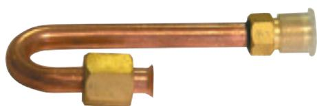
Racores de cobre espesor 1 mm a inversión de 180°. Permite las conexiones entre la unidad interna y los tubos de cobre predispuestos en sentido contrario.
