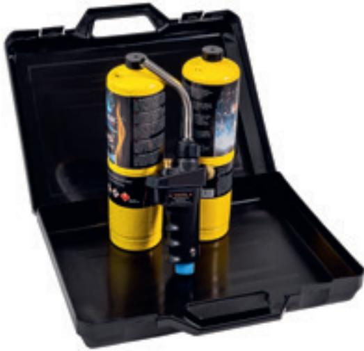
Encendido piezoeléctrico para llama instantánea. Bloqueo de Seguridad para evitar accidentes. Bloqueo de llama para uso continuo. Boquilla de latón extraíble - permite una fácil limpieza. Conexión CGA-600 a cilindro para cartuchos Map Pro, Propano. Control de llama ajustable por medio de rueda a la salida de la empuñadura. Temperatura de llama 1373°C (2500°F) Propano 1982°C (3600°F) MAP Pro.
