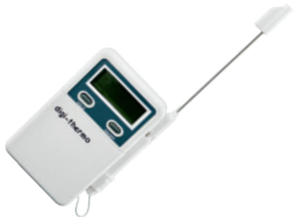
Precisión:  $\pm 1^{\circ}\text{C}$  ( $-20^{\circ}\text{C} \sim 80^{\circ}\text{C}$ ),  $\pm 5^{\circ}\text{C}$  a otras temperaturas, rango medida:  $-50^{\circ}\text{C} \sim 300^{\circ}\text{C}$ , tensión: DC 1.5 V, distinción lectura:  $\pm 0.1^{\circ}\text{C}$ . Conmutable entre  $^{\circ}\text{C}$  y  $^{\circ}\text{F}$ , temperatura máxima y mínima en memoria, temperatura y alarma programable, memoriza mediciones.
