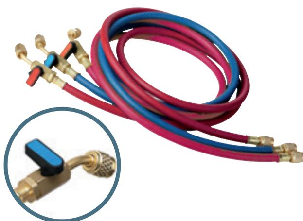
Manguera flexible para el vacío y carga para gases R22 - R407C - R404A - R134A - R410A. Con conexiones 1/4" SAE y variaciones de 5/16", con válvula, tubo con barrera de nailon, O-ring 1/4" SAE, presión máxima 60 bar.
