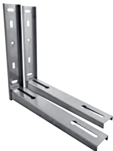
Pareja de soportes soldados en acero inoxidable AISI 304 realizados para una mayor resistencia a la corrosión. Realizados con agujeros en el brazo horizontal para una mayor facilidad de instalación de los amortiguadores y secciones elípticas en el brazo vertical Para facilitar la fijación de los tornillos a la pared.
