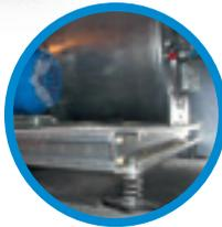
Los amortiguadores de suelo con muelle se usan principalmente para vibraciones de baja frecuencias (alrededor de 400 rpm) tales como compresores, refrigeradores, unidades de tratamiento de aire.
