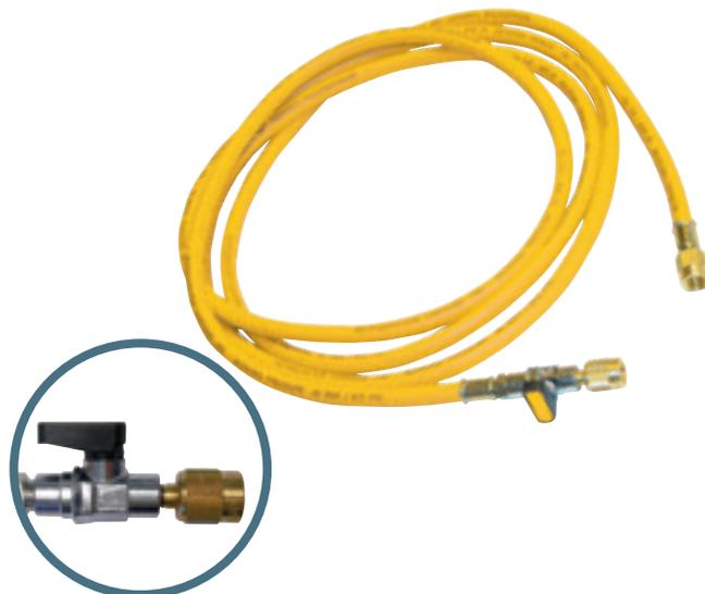
Manguera flexible para el vacío se utiliza para la conexión de la bomba y el grupo manométrico con conexiones 1/4" SAE, completo de válvula, tubo con barrera de nailon, O-ring en PTFE de 1/4" SAE, presión máxima 60 bar.
