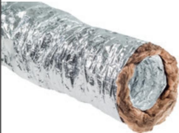
Tubo fabricado en multicapa de aluminio y poliéster, reforzado con una espiral de acero, recubierto con aislamiento de lana de roca y una capa de aluminio. El rendimiento cumple con los estándares EN13180. Aislamiento clase A1, certificado según EN 13501-1. Precio por unidad.
