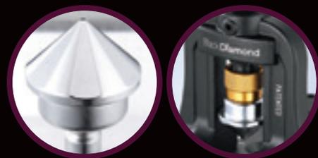
Herramienta patentada que se puede usar para abocardar o para ensanchar el tubo. El cono del abocardador escarifica y alisa la tubería durante la operación, creando un acabado superficial excepcional cuando el abocardado está completo. El racor de acoplamiento acoplador permite al usuario de quitar rápidamente el cono abocardado y las cabezas del ensanchador.
