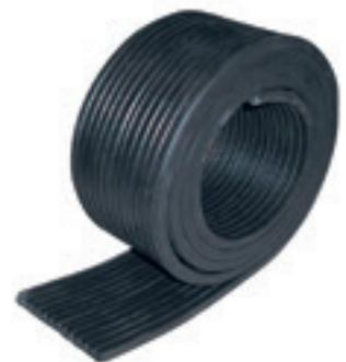
La tira de goma Vibro Strip principalmente se usa como base para los equipos y máquinas para lograr un control total de la vibración. También se usa como almohadilla elástica entre partes estructurales (columnas, paredes, puentes, tanques) para suavizar las fuerzas y movimientos entre las mismas. Gracias a su especial forma a V permite diferentes vías de instalaciones según la cantidad de reducción de vibraciones requerida. Rollos de 3 mt, espesor 10 mm, ancho 108 mm.
