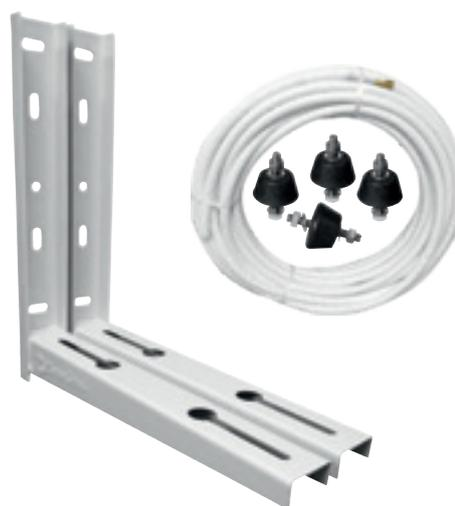
Contiene una pareja de soportes soldados de 450x450 mm, tubo doble de cobre aislado 1/4"-3/8" de 5 mts o de 3 mts, abocardado con tuercas y un juego de amortiguadores cod. 1901-3500. Kit de instalación con tubo de cobre aislado 1/4"-1/2" disponible bajo pedido.
