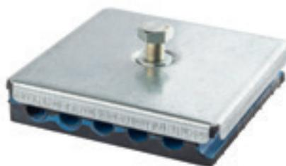
El modelo con una tapa metálica en acero galvanizado protege la goma de la radiación UV al mismo tiempo que permite una óptima distribución del peso en toda la superficie.
