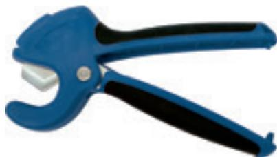
Herramienta para cortar tubería de plástico.
