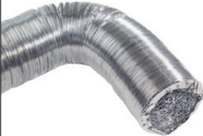
Los conductos no aislados son productos para calefacción, ventilación, extracción de humos y sistemas de aire acondicionado de presión media-baja. El tubo se produce con una multicapa de aluminio y poliéster, reforzado con una espiral de resorte de acero. Provisto de alta elasticidad y flexibilidad. Rendimiento según las normas EN 13180. Precio por unidad.
