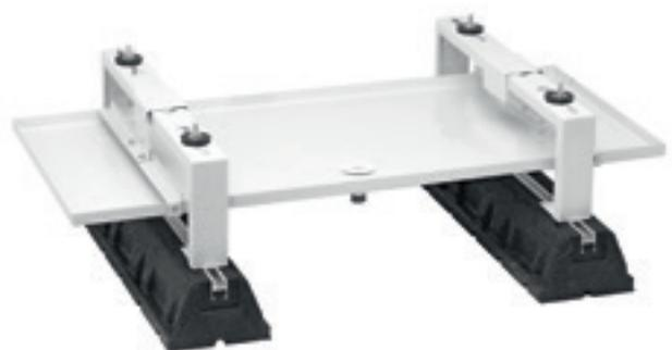
Kit de instalación de acero galvanizado pintado y soporte de caucho Brooklyn, completo con bandeja de para el desagüe y codo de Ø 20 mm. Diseñado para la aireación correcta de las bombas de calor con una altura de 200 mm y gracias a las bases de goma absorben las vibraciones del suelo.
