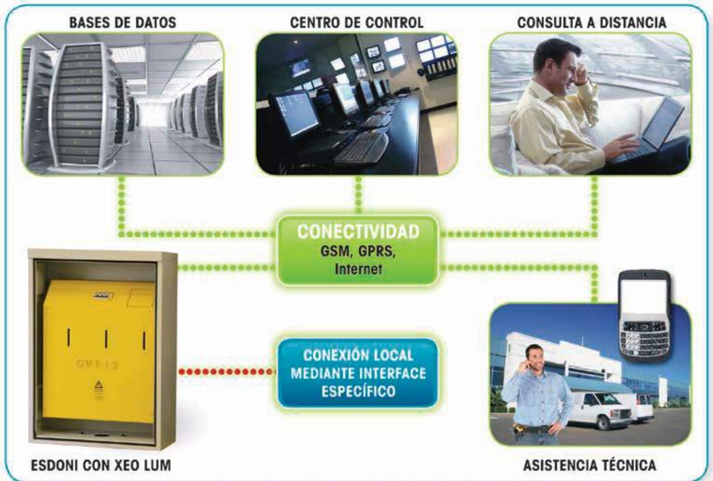
Esquema de funcionamiento del software Xeo Lum
