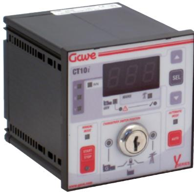
La central de control CT10 permite la transferencia automática entre una fuente de línea y un generador. En caso de fallo de red, la central da orden de arranque al generador y cuando la tensión y frecuencia se estabilizan dentro de los parámetros programados, la central controla automáticamente la conmutación de carga al lado del generador. Cuando se restaura la alimentación de la línea principal, se produce la conmutación automática a red y el generador se para.
