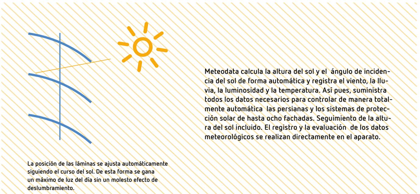
Para una protección antideslumbrante efectiva con seguimiento de la altura del sol
