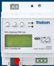
La pasarela DALI KNX plus une el protocolo DALI del control de luz digital con la automatización general en todas las habitaciones. Controla hasta 64 equipos con interfaz DALI por separado y o en grupos. La puesta en marcha puede ejecutarse a través de ETS 5 (DCA) o a través de la interfaz web integrada con un equipo terminal móvil. Otra característica destacada es la compatibilidad de DALI DT8 que permite el control de color y temperatura de color.
