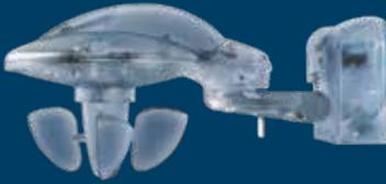
La conjunción de sensor combinado, estación meteorológica y receptor GPS integrado convierte a la Meteodata 140 S GPS KNX en una auténtica experta en meteorología. El cálculo del acimut y de la elevación se realiza de forma automática. La temperatura, la lluvia, el viento y la luminosidad se registran con exactitud. Gracias a sus tres sensores de luminosidad, la estación meteorológica permite controlar la protección solar de hasta ocho fachadas.
