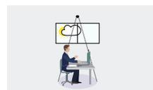
Además de la tecnología **Tunable Light**, es posible integrar **sensores de presencia y de luminosidad** que permitan ajustar la iluminación artificial, manteniendo el valor de la luz establecido en función de la presencia de personas y de la contribución de luz natural. El sensor de luz integrado mide constantemente el valor de luminosidad en el entorno y compara este valor con el valor configurado en el detector de presencia.
