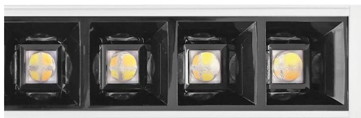
Óptica dark light de alvéolos con parábola doble, de aluminio espejular 99,99, antirreflejo y anti-iridiscente, de muy baja luminancia con tratamiento de PVD.
