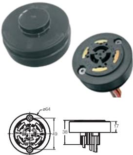
El estándar codificado ANSI C136 define claramente el tamaño de los enchufes, el tipo de bloqueo y otros detalles. Este dispositivo proporciona una conexión entre la alimentación de la red y las señales de control, con contactos robustos provistos de apriete de par.
