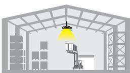
Cuando el sensor capta un movimiento en la zona de monitorización, la luminaria se ajusta al 100% de la luz automáticamente.
