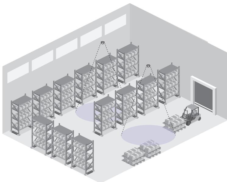
El alumbrado es necesario en función del movimiento en cada uno de los pasillos y pasos de un almacén. Los conductores de las carretillas elevadoras o los trabajadores en el pasillo principal y en los demás pasillos no tendrán que encender las luces. La luz tendrá que encenderse solo en caso de presencia en los pasos y pasillos.
