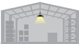
Si el sensor no capta ningún movimiento, la luminaria permanece con un nivel de luz constante programado previamente durante un tiempo preestablecido.
