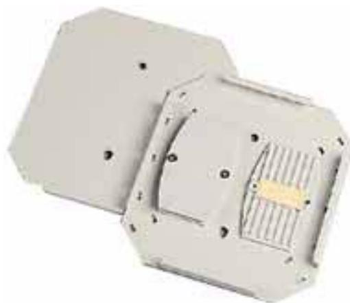
**Caja Mural de Fibra Óptica.** Las cajas mural es una solución eficiente en las instalaciones de fibra óptica en las cuales no podamos ubicar los Racks de distribución. Equipada con un panel vacío y extraíble para poder alojar doce adaptadores ST o doce adaptadores SC Duplex. Fabricada en acero con espesor de 1,2 mm de color negro, los laterales troquelados para prensaestopas y guía fibras para una correcta distribución interior de las fibras ópticas.
