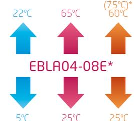
Rango de funcionamiento de temperatura ambiente exterior
