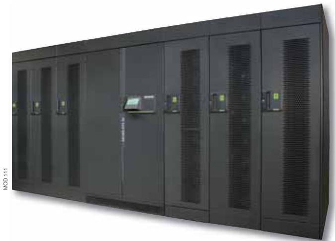
El MODULYS XL es un SAI modular basado en módulos de potencia de 200 kW. La potencia de una sola unidad SAI se puede aumentar hasta 1200 kW y el sistema puede incluir hasta 4 unidades en paralelo.
