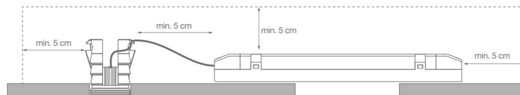
Recuerde que el **agujero para empotrar** la luminaria es de 30 mm y la caja de la electrónica (40 mm) no cabe a través del agujero para la luminaria. Esta luminaria está diseñada para techos registrables y para luminarias de tiras continuas.
