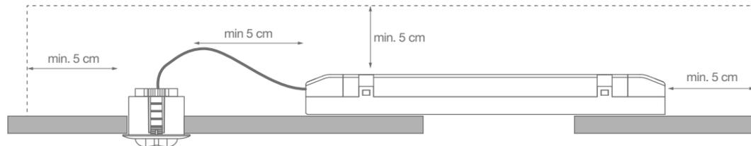
Recuerde que el **agujero para empotrar** la luminaria es de 29 mm y la caja de la electrónica (40 mm) no cabe a través del agujero para la luminaria. Esta luminaria está diseñada para techos de lamas de madera y para luminarias de tiras continuas.
