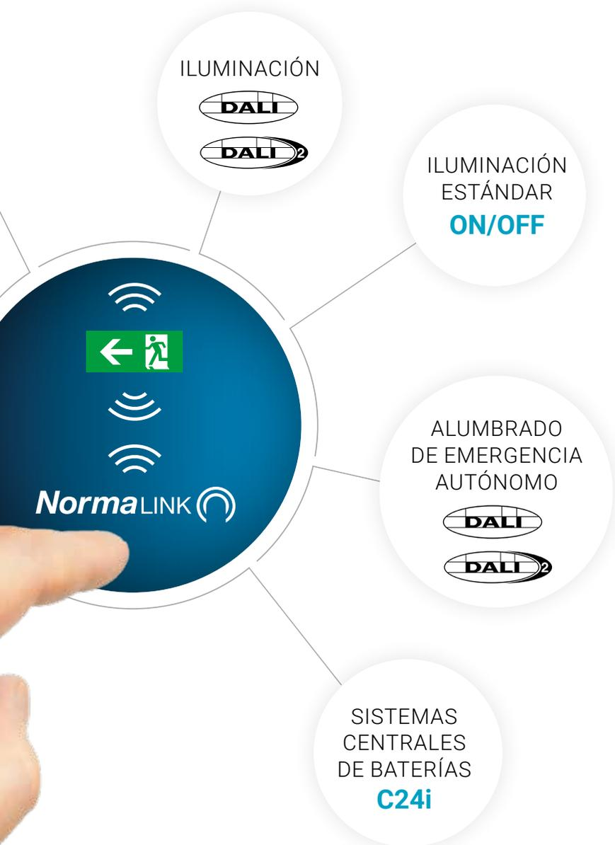
**El sistema Inteligente Wireless de Normalink** se basa en un radio enlace con conexión ethernet (ref. IDNGR16K) capaz de controlar hasta 16.000 luminarias de emergencia Normalux compatibles con la versión Inteligente Wireless. Este radio enlace se conecta directamente a la red local y requiere de una pasarela maestra para su funcionamiento.
