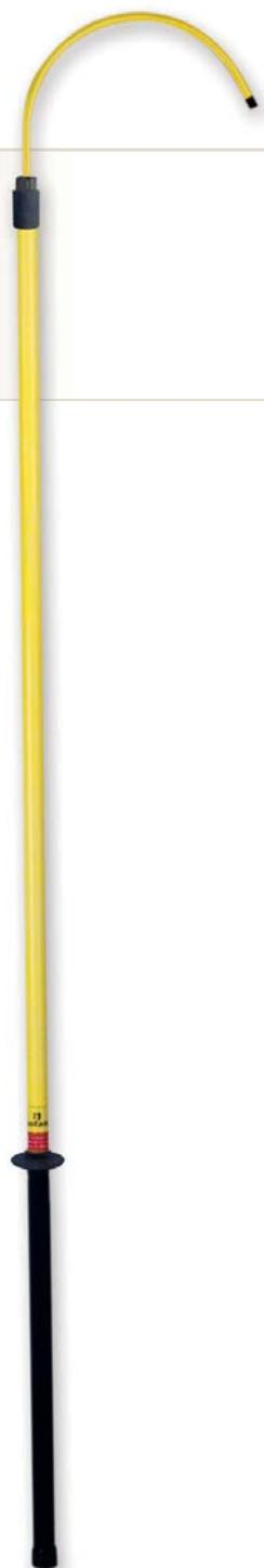
Pértigas de salvamento de un solo tramo fabricada en tubo de poliéster y fibra de vidrio de Ø 32 mm dotada de obturaciones antihumedad en ambos extremos, guardamanos, empuñadura, contera, cabezal métrico M-10 y gancho de salvamento.
