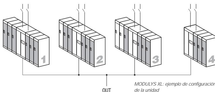
MODULYS XL: ejemplo de configuración paralela de la unidad
