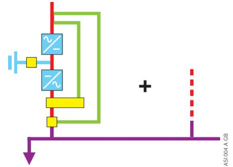
Unidad única con bypass o configuración redundante 1+1
