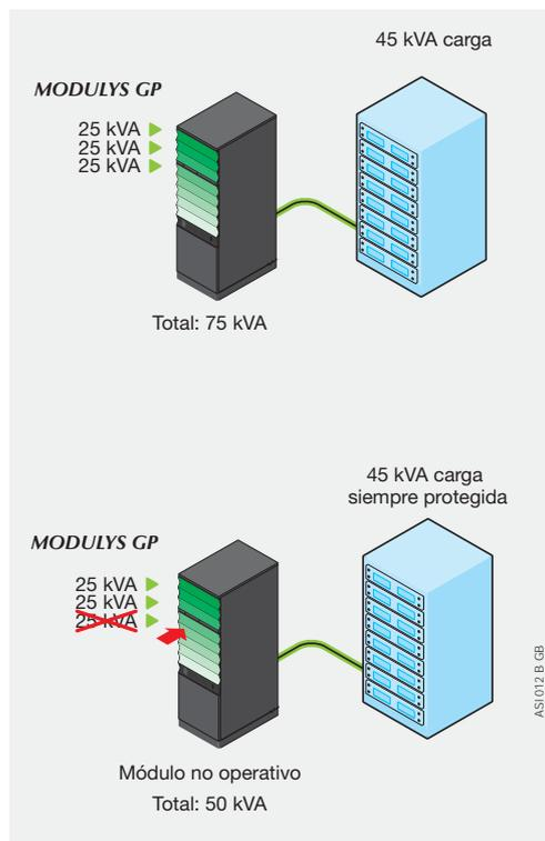
Configuración redundante escalable
