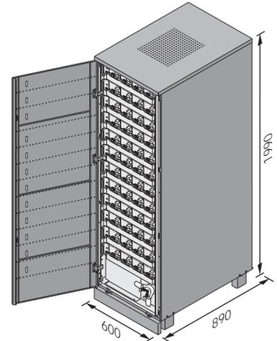
Armario para baterías intercambiables en caliente - media capacidad
