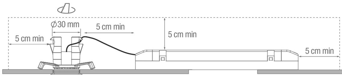
Recuerde que el **agujero para empotrar** la luminaria es de 30 mm y la caja de la electrónica (40 mm) no cabe a través del agujero para la luminaria. Esta luminaria está diseñada para techos registrables y para luminarias de tiras continuas.
