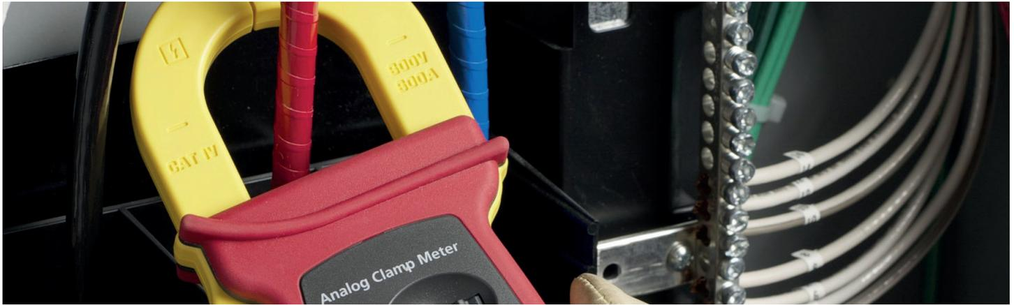
Nuestras pinzas localizadoras de fugas son una herramienta esencial para llevar a cabo mantenimientos en instalaciones eléctricas, permiten medir la corriente de fuga a tierra de forma rápida y sencilla.
