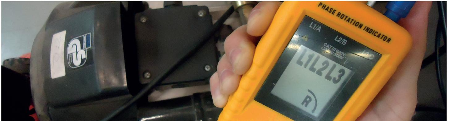
El comprobador de giro de fases posee una carcasa robusta con una gran pantalla LCD, que le facilita trabajar de forma sencilla y cómoda la dirección de rotación de fases.
