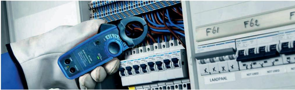
El maxilar de corriente permite convertir un multímetro o medidor en una pinza amperimétrica mediante su interconexión; capta la medida y la convierte en un valor mV que lee el multímetro o instrumento al que se conecta.
