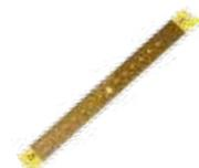
Resistencia de calibración
