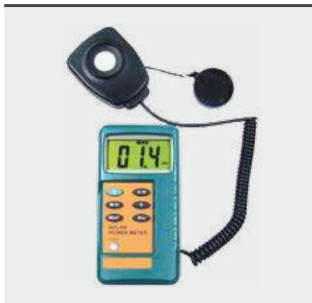
**Multímetro fotovoltaica / Medidor de irradiancia**
