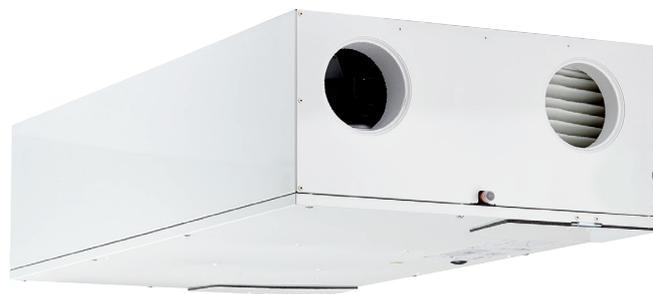
VMC de doble flujo para viviendas, con intercambiador de calor de tipo contraflujo de alto rendimiento (hasta el 95%), con motor EC de corriente continua de bajo consumo y bajo nivel sonoro.
