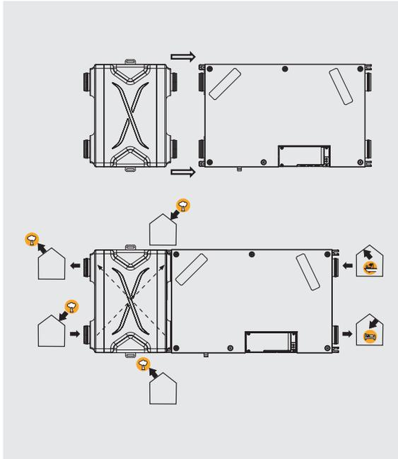
**Montaje con conductos**
