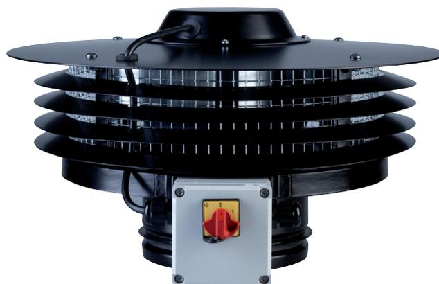
Ventiladores centrífugos de tejado, para montar directamente a conducto circular, para la ventilación de viviendas y pequeños recintos, en cumplimiento del Código Técnico de Edificación, con rodete de álabes hacia atrás de chapa de acero galvanizada, estructura de chapa galvanizada protegida por pintura poliéster negra, malla de seguridad antipájaros de chapa galvanizada, interruptor paro-marcha IP55, junta de estanqueidad en la brida de acoplamiento al conducto y protector térmico.
