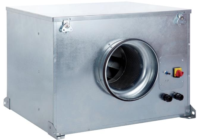
Cajas de ventilación estancas, de bajo nivel sonoro, fabricadas en chapa de acero galvanizado, con aislamiento acústico ininflamable (M0) de fibra de vidrio de 50 mm de espesor, silenciador acústico en la aspiración, juntas estancas en aspiración y descarga, cierres estancos de tipo tracción giratorio, de fácil apertura, y ventilador centrífugo de álabes hacia atrás.
