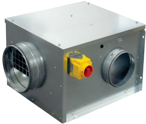
Cajas de ventilación autorregulables, de acero galvanizado, capacidades para trasegar aire a 400°C-1/2h para la extracción de aire en caso de incendio, equipadas con un ventilador centrífugo de accionamiento directo, con rodete de álabes hacia adelante.
