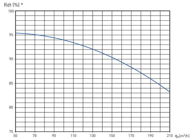
\* Eficiencia húmeda referida a caudal nominal, condiciones exteriores (7°C 88% RH) e interiores (20°C/38%RH).
