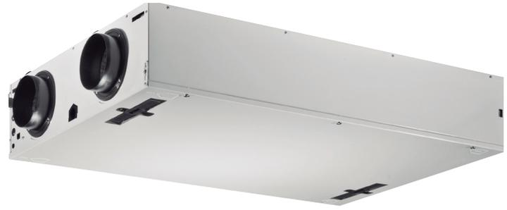
VMC de doble flujo para viviendas, con intercambiador de calor de tipo contraflujo de alto rendimiento (hasta el 95%) y motor EC de corriente continua, de muy bajo consumo.
