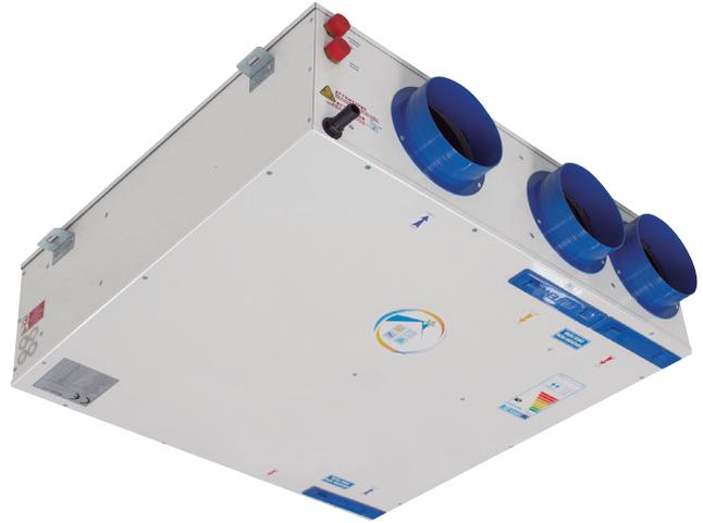
VMC de doble flujo para viviendas, con intercambiador de calor entálpico, de tipo contraflujo, con un rendimiento hasta el 83%.
