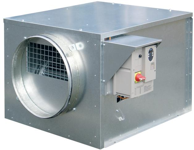
Cajas de ventilación auto/higrorregulables, de acero galvanizado, certificadas 400°C-1/2h para la extracción de aire en caso de incendio y especialmente diseñadas para mantener una presión constante en la instalación.
