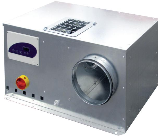
Cajas de ventilación higrorregulables, de acero galvanizado, certificadas 400°C-1/2h para la extracción de aire en caso de incendio, equipadas con un ventilador centrífugo de accionamiento directo, con rodete de álabes hacia adelante.
