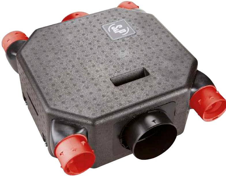
Grupo autorregulable de VMC, Ventilación Mecánica Controlada, de bajo perfil y bajo nivel sonoro, que asegura la renovación permanente de aire en viviendas. Garantiza los requisitos establecidos en el Código Técnico de la Edificación. La unidad se complementa con entradas de aire autorregulables en las habitaciones principales (salón y dormitorios) y con bocas de extracción autorregulables en las zonas húmedas (baños y cocina).
