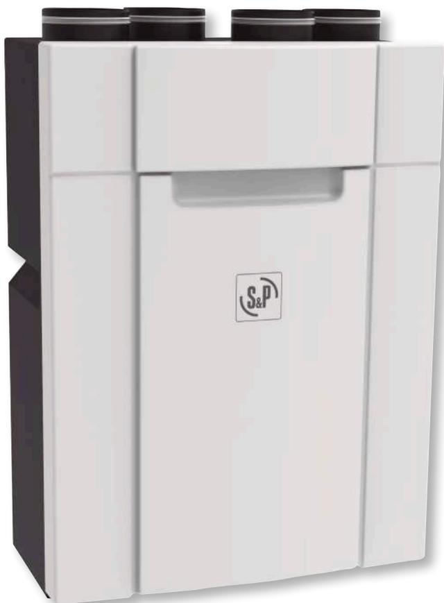
VMC de doble flujo para viviendas, con intercambiador de calor de tipo contraflujo de alto rendimiento (hasta el 92%) y motor EC de corriente continua, de muy bajo consumo.
