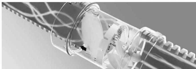
Este elemento permite ajustar el caudal del ramal donde esté instalado de una manera sencilla y rápida. Hasta un máximo de 40 m<sup>3</sup>/h, sólo aporta 1 PA de pérdida de carga en su apertura máxima.
