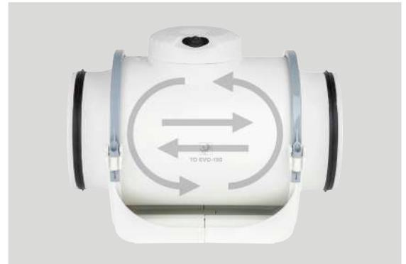
Para invertir la dirección del flujo de aire, simplemente se debe girar el cuerpo del ventilador sin tener que desmontar el pie-soporte. La rotación del cuerpo del ventilador también permite colocar la caja de bornes donde sea más accesible.
