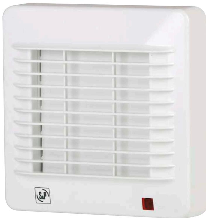
Ventiladores helicoidales, con caudal aproximado de 100 m<sup>3</sup>/h, luz piloto de funcionamiento (1), motor 230V-50Hz, IP44 (2), Clase II (3), con protector térmico, para trabajar a temperaturas de hasta 40°C.
