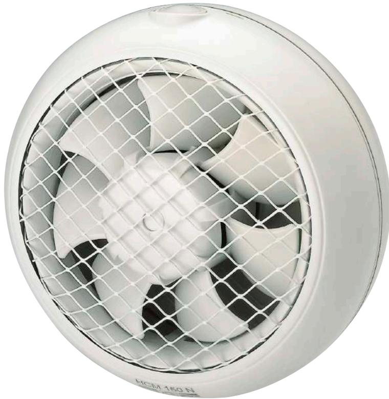
Ventiladores helicoidales para instalar en cristal o pared, con carcasa de plástico ABS, persiana de sobrepresión incorporada, rejas de seguridad en aspiración y descarga, motor 230V-50Hz, clase B, IPX4, Clase II, con protector térmico mediante fusible.
