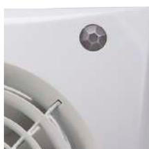
Dispone de detector de presencia por infrarrojos. El aparato se pone en funcionamiento de manera automática cuando detecta movimiento, a una distancia máxima de 4 metros. Incorpora también temporizador regulable entre 1 y 30 minutos, periodo durante el cual el aparato seguirá funcionando tras la detección del movimiento.
