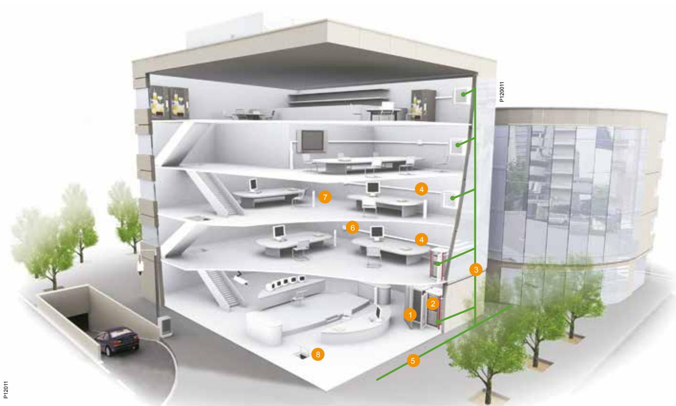
La oferta LAN de fibra cubre las necesidades de cualquier tipo de instalación LAN: Campus (entre edificios), redes troncales de edificios (entre salas técnicas) y distribución (desde salas técnicas hasta estaciones de trabajo).
