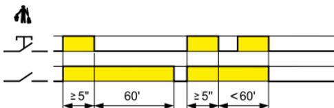
**(MP)** Automático de escalera rearmable con preaviso de apagado + Limpieza de escalera
