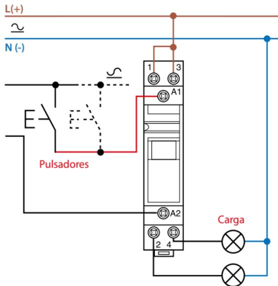
Conexión del mando con alimentación coincidente con la red y utilización de pulsadores luminosos
