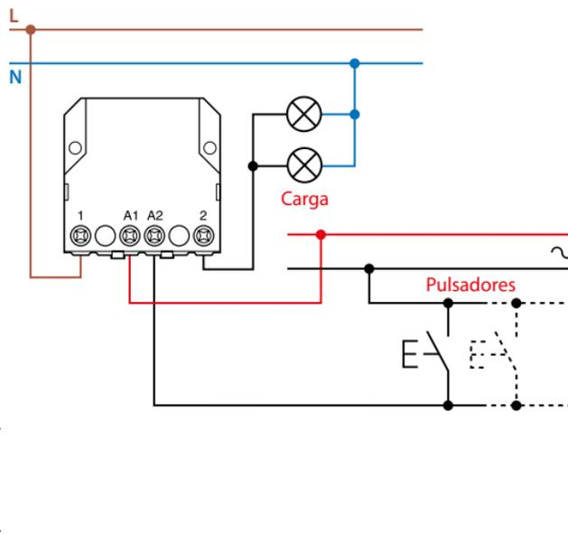
Conexión del mando con alimentación con la red y utilización de pulsadores luminosos
