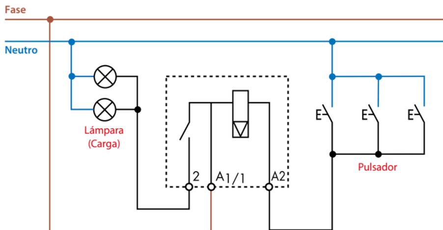
Ejemplo de instalación con telerruptor tipo 27.01.
