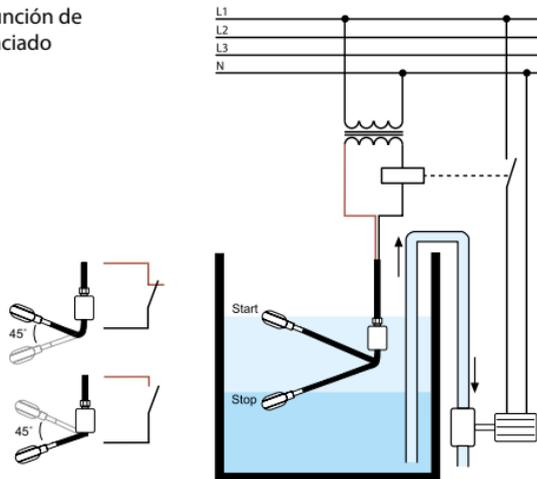
Conectando el hilo negro y el marrón, el circuito cierra cuando el flotador está arriba y abre cuando el flotador está abajo.
