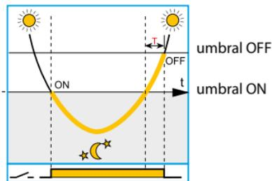
Generalmente un relé crepuscular tradicional trabaja con histéresis positiva para prevenir malfuncionamiento o rateo, significando el apagado retardado un derroche de energía (T).
