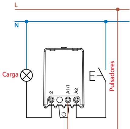
Conexión del mando con alimentación con la red y utilización de pulsadores luminosos
