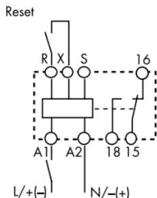
Esquema de conexión (sin señal de mando)
