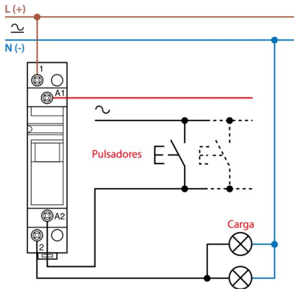
Conexión del mando con alimentación coincidente con la red y utilización de pulsadores luminosos
