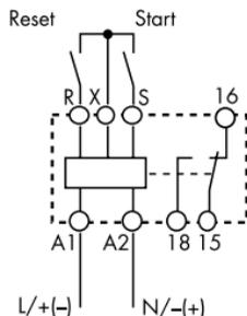
Esquema de conexión (con señal de mando)
