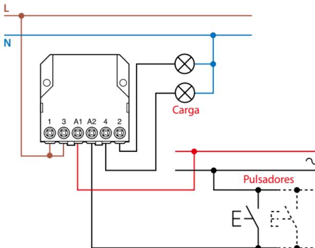
Conexión del mando con alimentación con la red y utilización de pulsadores luminosos
