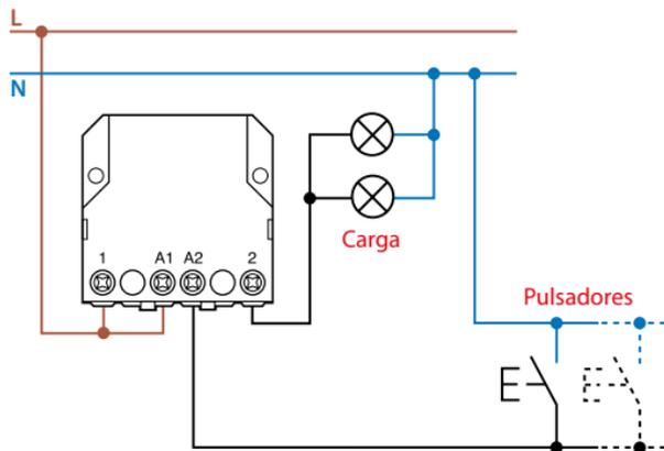
Conexión con mando a muy baja tensión alterna
