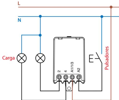
Conexión del mando con alimentación con la red y utilización de pulsadores luminosos
