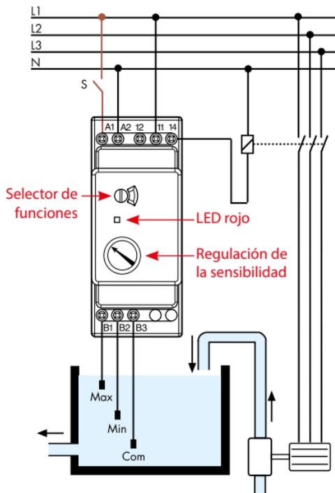
Esquemas de conexión con 2 sondas
