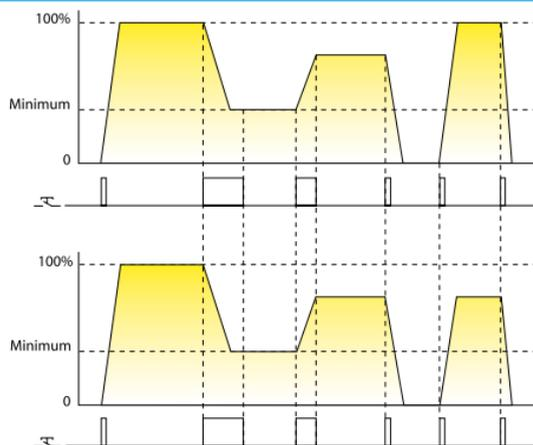
**Modo de funcionamiento sin memoria:** en la desconexión no se memoriza el nivel de luz ajustado.
