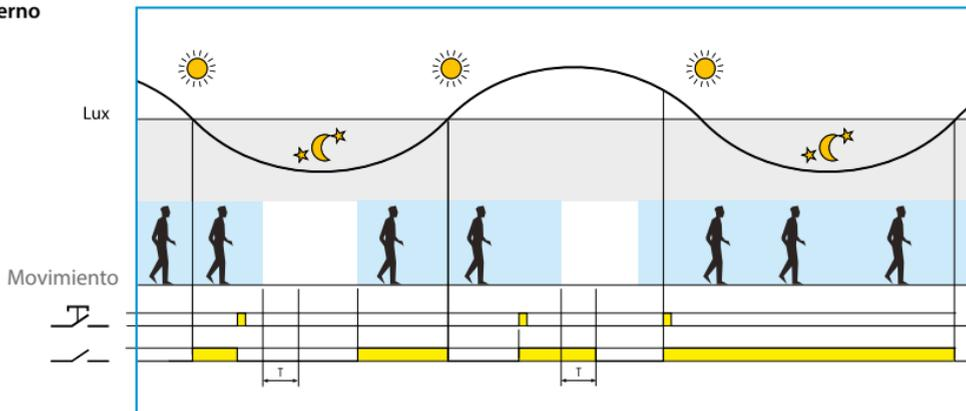
Un impulso de mando desde un pulsador, invierte el estado del relé de salida hasta transcurrido el tiempo ajustado, a partir de la última detección de movimiento.
