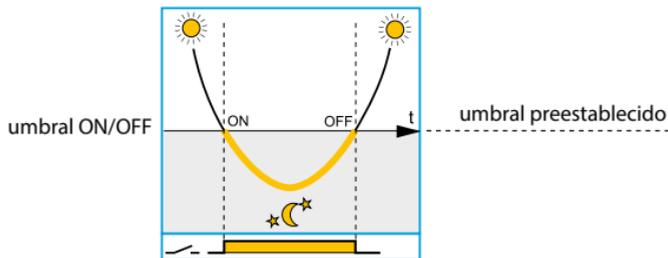
El crepuscular con HISTÉRESIS CERO garantiza el encendido y apagado en el nivel fijado
