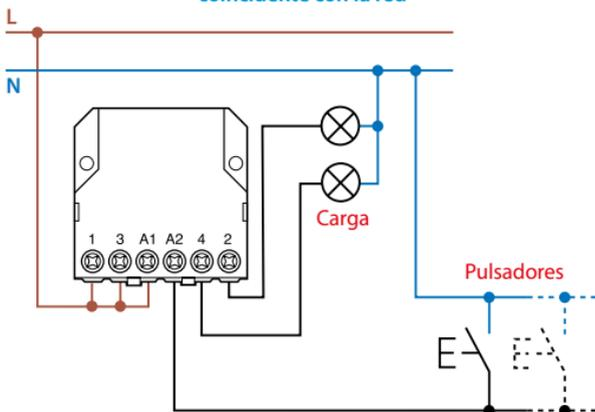
Conexión con mando a muy baja tensión alterna
