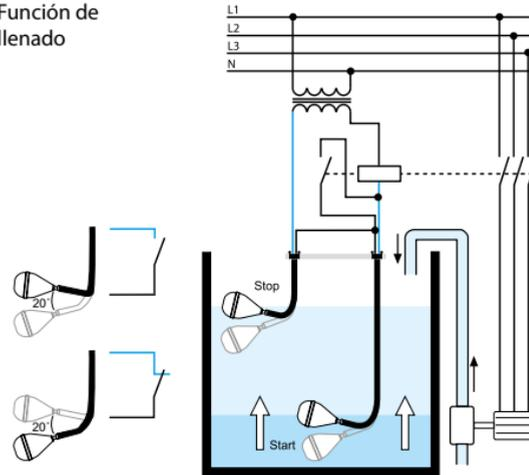
Conectando el hilo negro y el azul/gris, el circuito abre cuando el flotador está arriba y cierra cuando el flotador está abajo.
