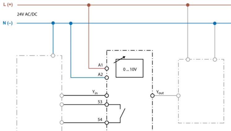
Con el selector en posición A (Automático) la señal (0 ...10) V de Y-in - A2 es conducida por Y-out al proceso final.
