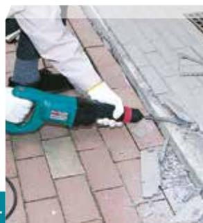
Especialmente diseñado para levantar pavimentos, azulejos, baldosas, hormigón...
