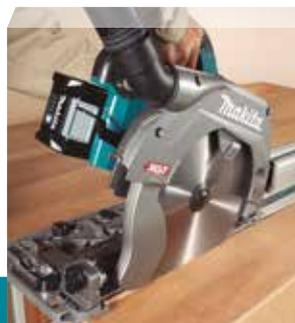
HS009GZ: llave hexagonal 6mm, guía paralela y disco HM 235. Sin baterías, sin cargador y sin maletín en equipo básico.
