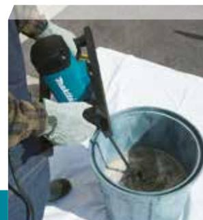
Idóneo para mezclar materiales de alta viscosidad como mortero, yeso prefabricado, cemento, cal, hormigón, resinas... hasta 90 Kg.
