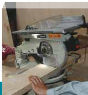
Equipo básico: Disco HM 260, llave de tubo, soporte lateral, bolsa para polvo, tope lateral superior y palo de empuje.
