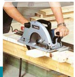
Equipo básico: Disco HM 270, guía paralela, toma de aspiración y llave hexagonal 6mm.
