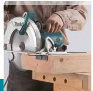
Equipo básico: Disco HM 270, guía paralela, toma de aspiración y llave hexagonal 6mm.
