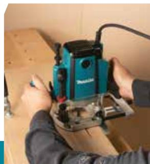
Fresadora de superficie con capacidad de inmersión de 70mm.
