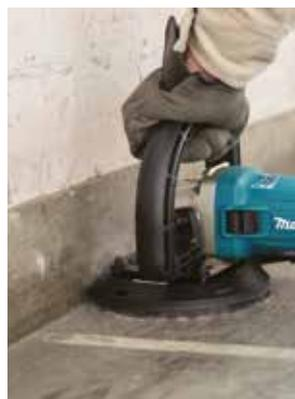
La cubierta frontal extraíble permite debastar al ras de las paredes o esquinas.
