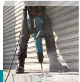
Especial para trabajos en suelo. Regulador electrónico de la velocidad.
