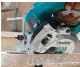
Capacidad de profundidad de corte ajustable de hasta 1-9/16" a 99°; cortes de bisel 45°
