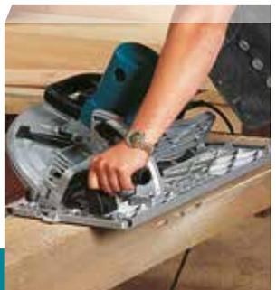
Equipo básico: Disco HM 355, guía paralela, toma de aspiración y llave hexagonal 6mm.
