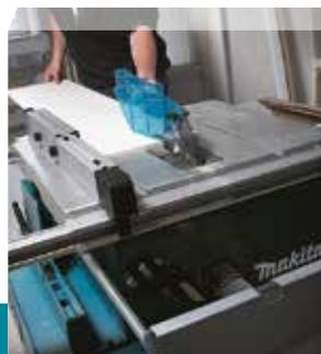
Equipo básico: Disco HM 260, guía paralela, guía de inglete, llave allen, 2 llaves fijas, extensión trasera y palo de empuje.
