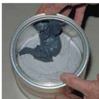
Vertido del componente B sobre el A.
