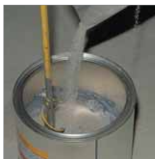
Vertido del componente C sobre la mezcla A+B.
