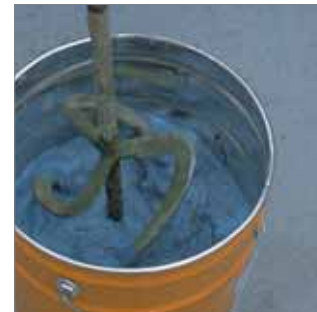
Homogeneización de la mezcla.
