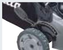
Palanca para ajustar la altura del corte.
