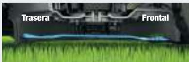
Mayor rendimiento de siega. La hoja está diseñada para que se incline hacia el lado frontal del cortacésped, lo que evita el doble corte y reduce el consumo de corriente.
